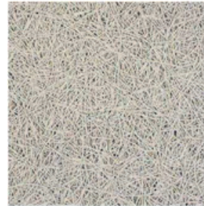
Decken gedämmt Mehrschicht-Dämmplatte Unitex, teilweise an Decke
